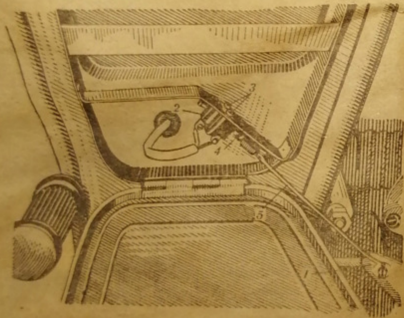
Рис. 28. РЕГУЛИРОВКА ВКЛЮЧАТЕЛЯ СТОП-СИГНАЛА:
