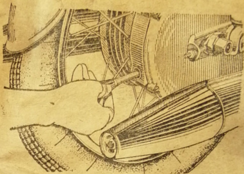
Рис. 21. РЕГУЛИРОВКА НОЖНОГО ТОРМОЗА
